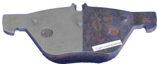
Halbseitig laservorbehandelter Bremsbelag (Stückpreis ca. 1 ct pro Bauteil)
