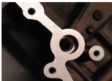
Dichtkontur mit erhaltener Frässtruktur nach der Laserbearbeitung
