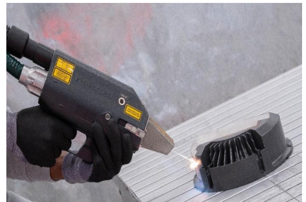
Passende Optik zur gleichmäßig flächigen Verteilung des Laserstrahls
