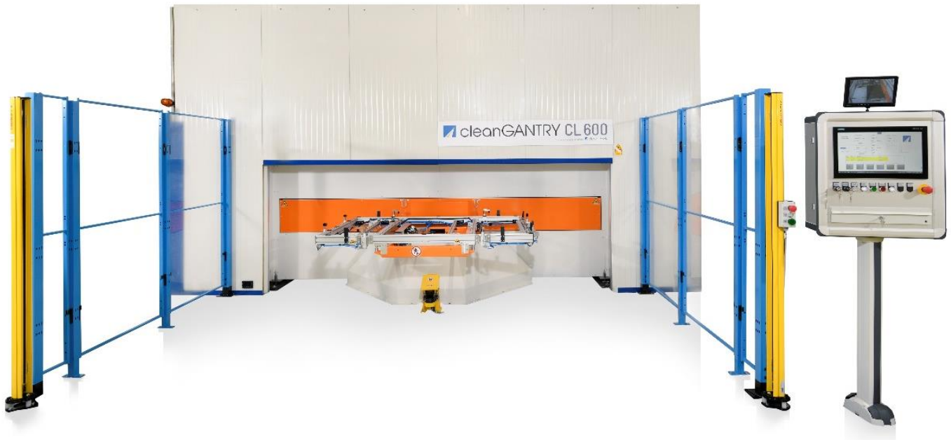
cleanGANTRY mit Rundschalttisch und lasersicherer Einhausung
