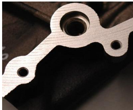
Dichtkontur mit erhaltener Frässtruktur nach der Laserbearbeitung
