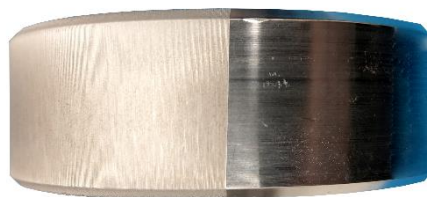
Links: laserbearbeitet rechts: unbearbeitet
