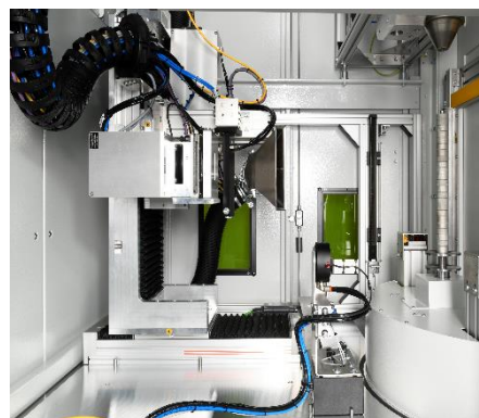
Rechts: Dorn mit Rollen Links: Laseroptik mit 90°-Anordnung
