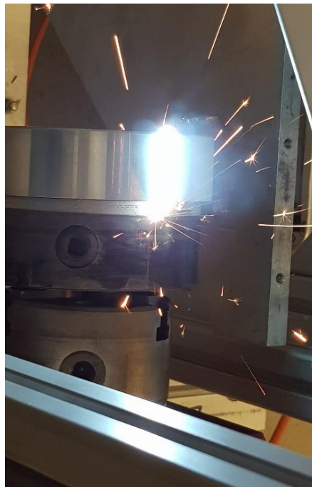
Laserbearbeitung einer Felge
