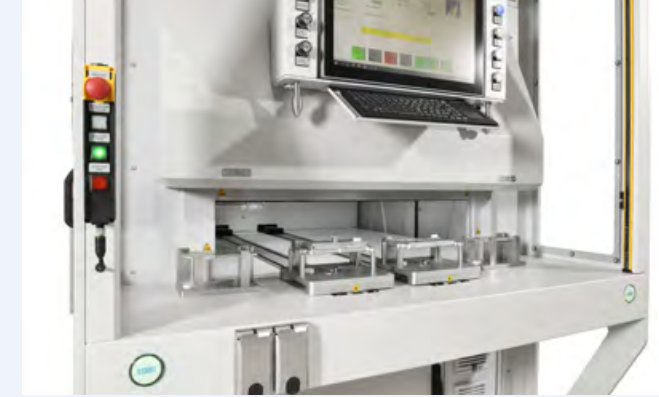
cleanCELL 2220 zur Klebevorbehandlung von Steuergeräten
